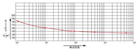
● 3%塩化ナトリウム水溶液滴下(1滴/秒)中における回転曲げ疲労試験 腐食疲労限度= 235N/mm²
