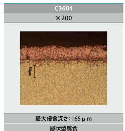
※脱亜鉛腐食試験は、すべて棒材の横断面部で行っています。
